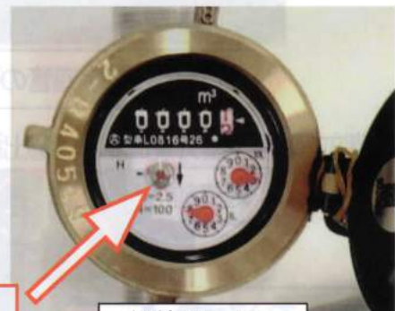
水道メーター
